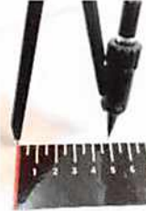
段ボールを下敷きにして、針を刺して長さを調整する。
